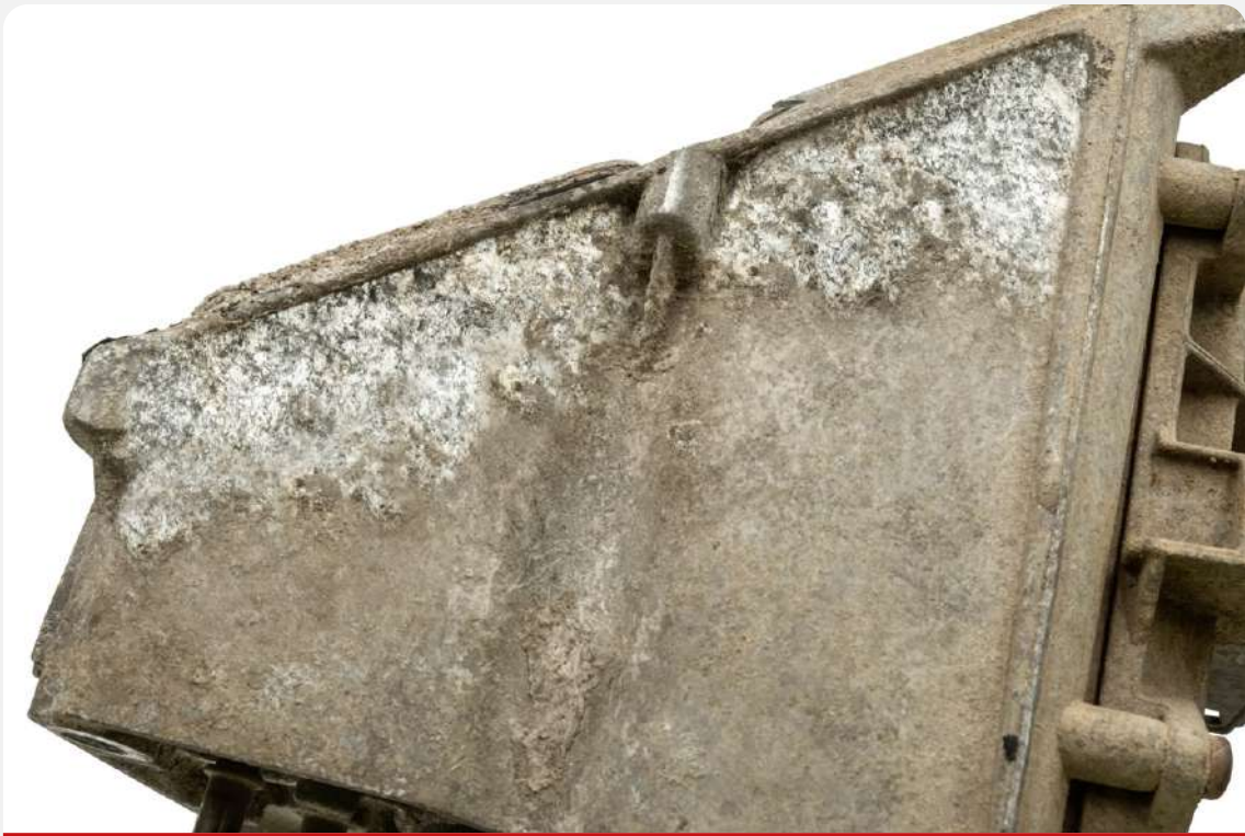
Uszkodzenia korpusu np. utlenienie
