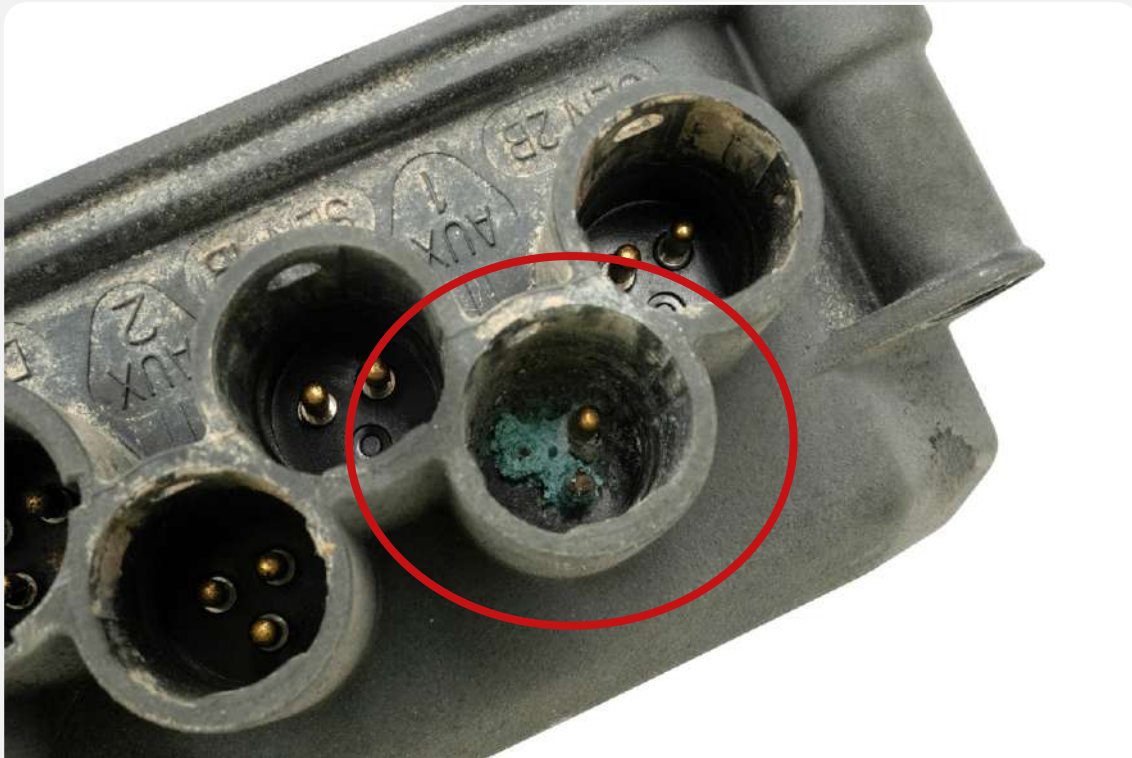
Korozja pinów elektonicznych
