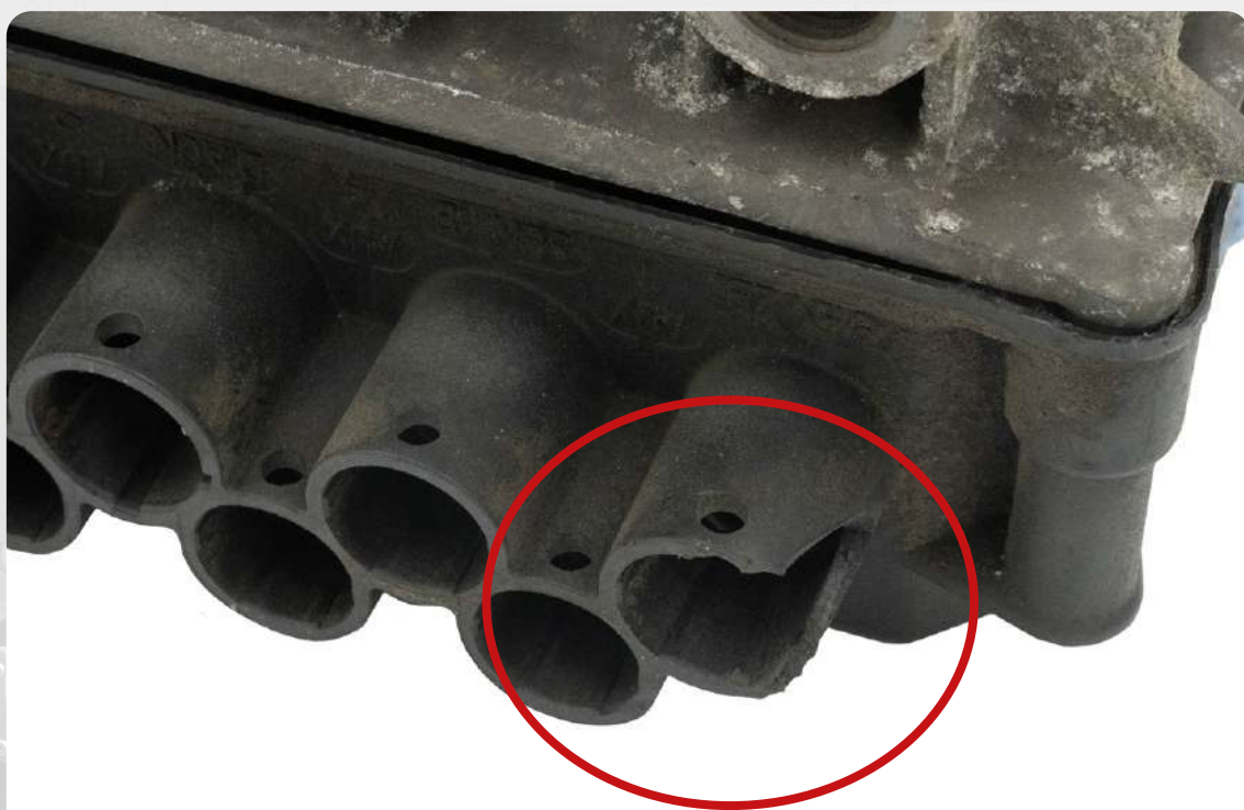
Uszkodzenia gniazd elektronicznych
