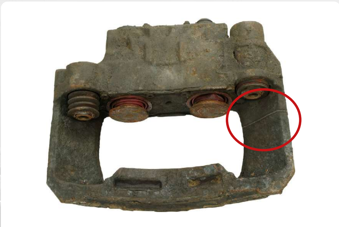
Rdzeń ze śladami spawania
