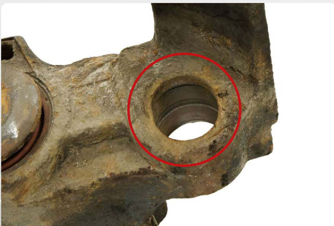
Zniekształcenie rdzenia bądź jego elementu
