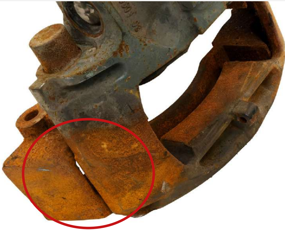
Rdzeń przepalony, przegrzany
