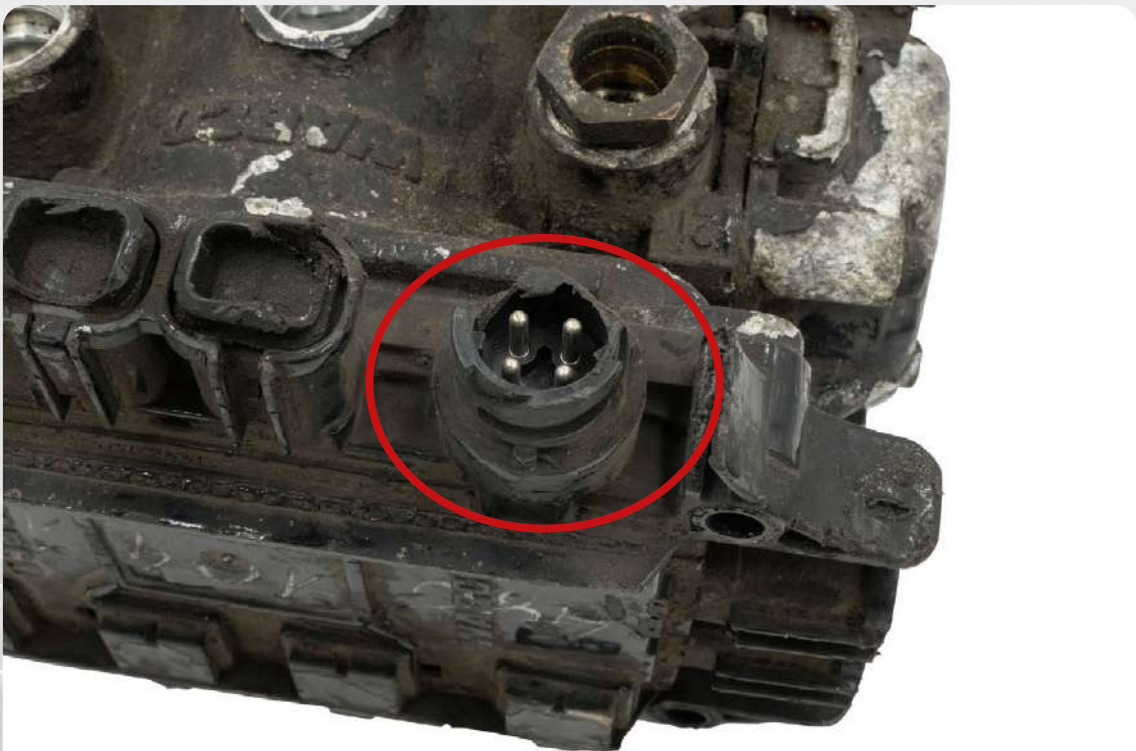
Uszkodzone gniazdo elektroniki
