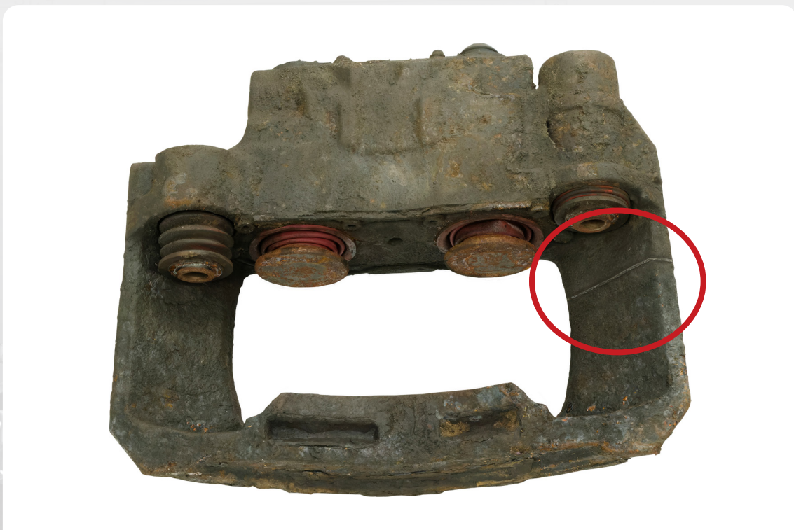
Rdzeń ze śladami spawania
