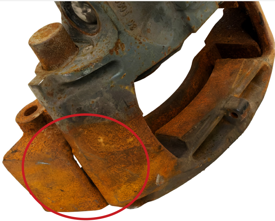
Rdzeń przepalony, przegrzany
