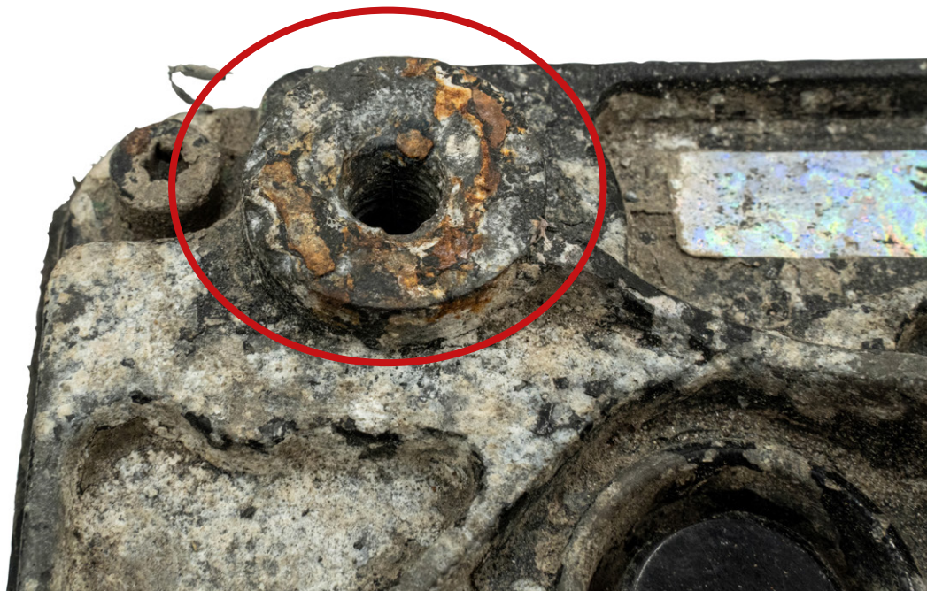
Uszkodzenia gwintów montażowych
