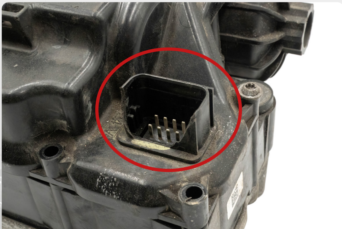
Uszkodzenia gniazda elektronicznego
