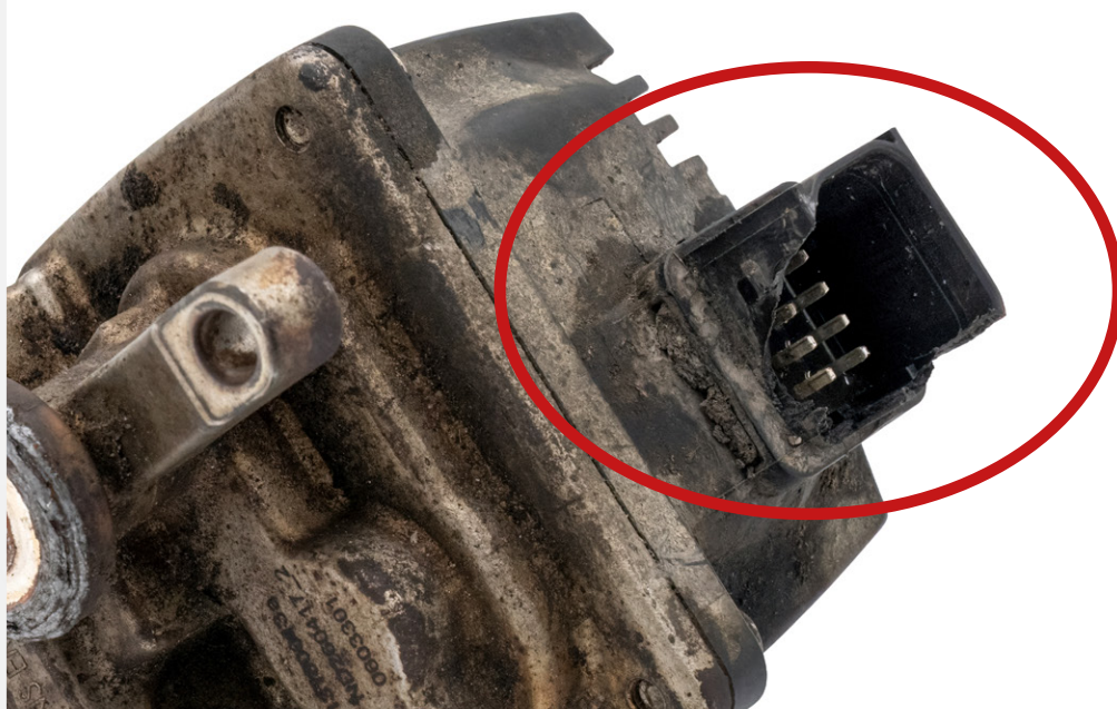
Uszkodzenie/utlenienie gniazd elektronicznych
