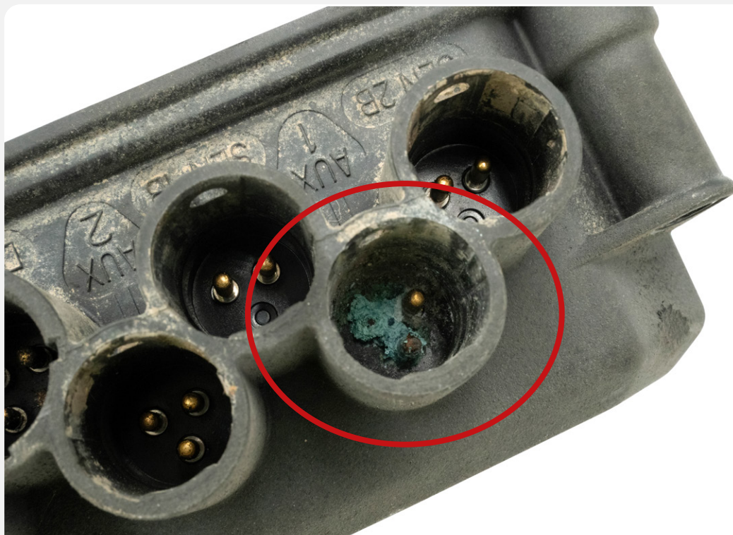
Korozja pinów elektonicznych
