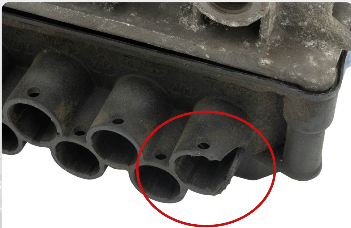
Uszkodzenia gniazd elektronicznych
