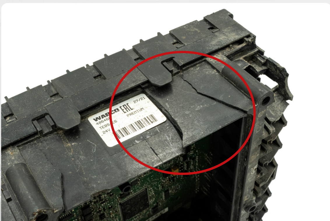
Uszkodzona obudowa / pokrywa plastikowa
