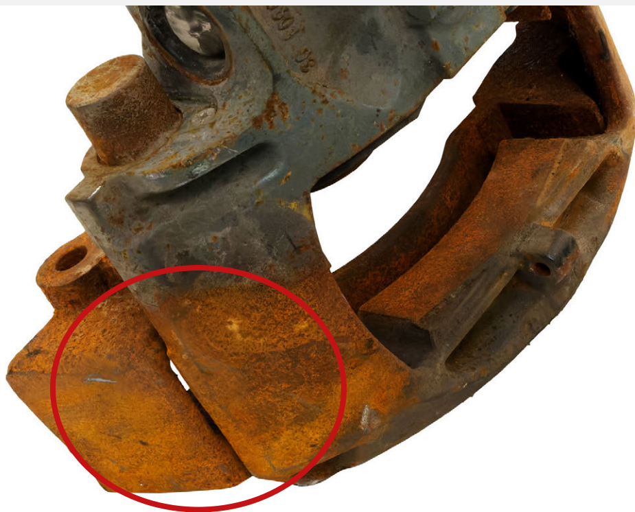
Rdzeń przepalony, przegrzany
