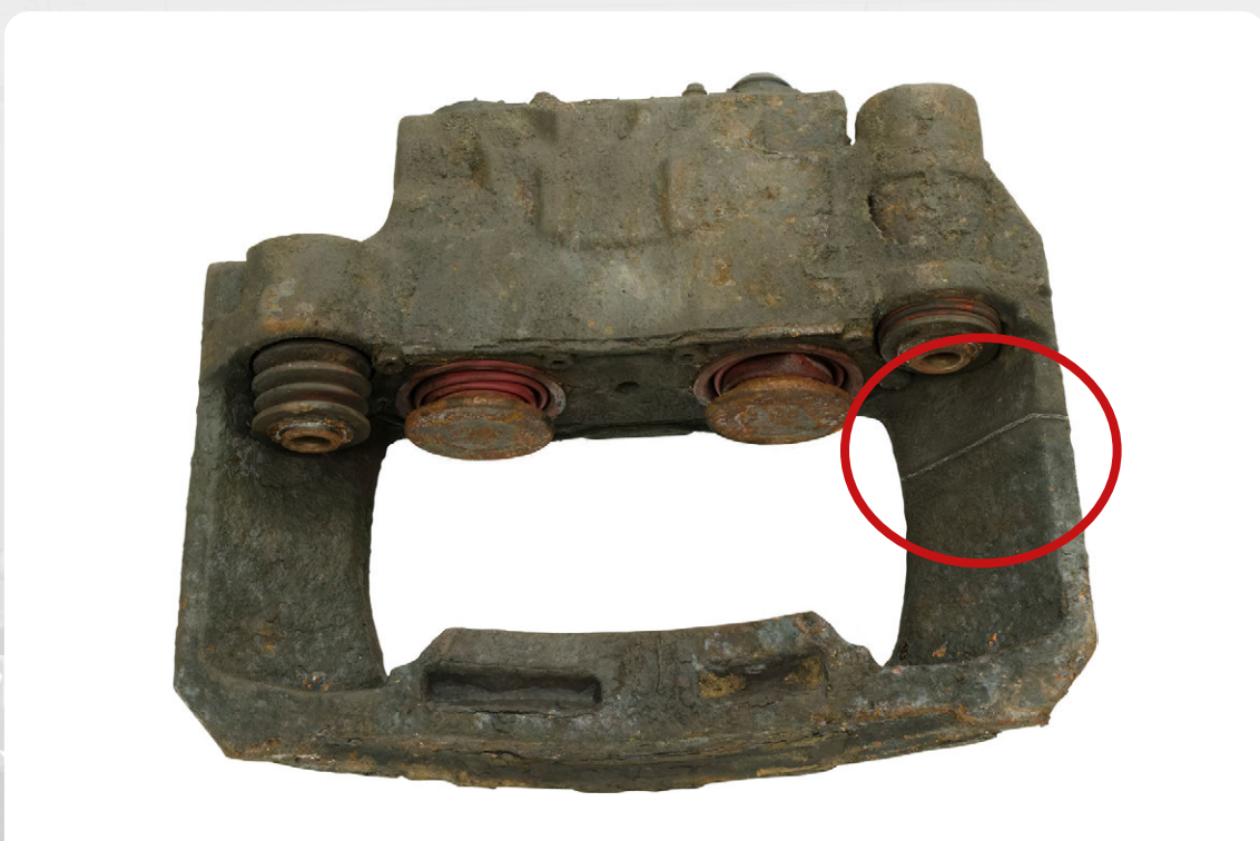
Rdzeń ze śladami spawania
